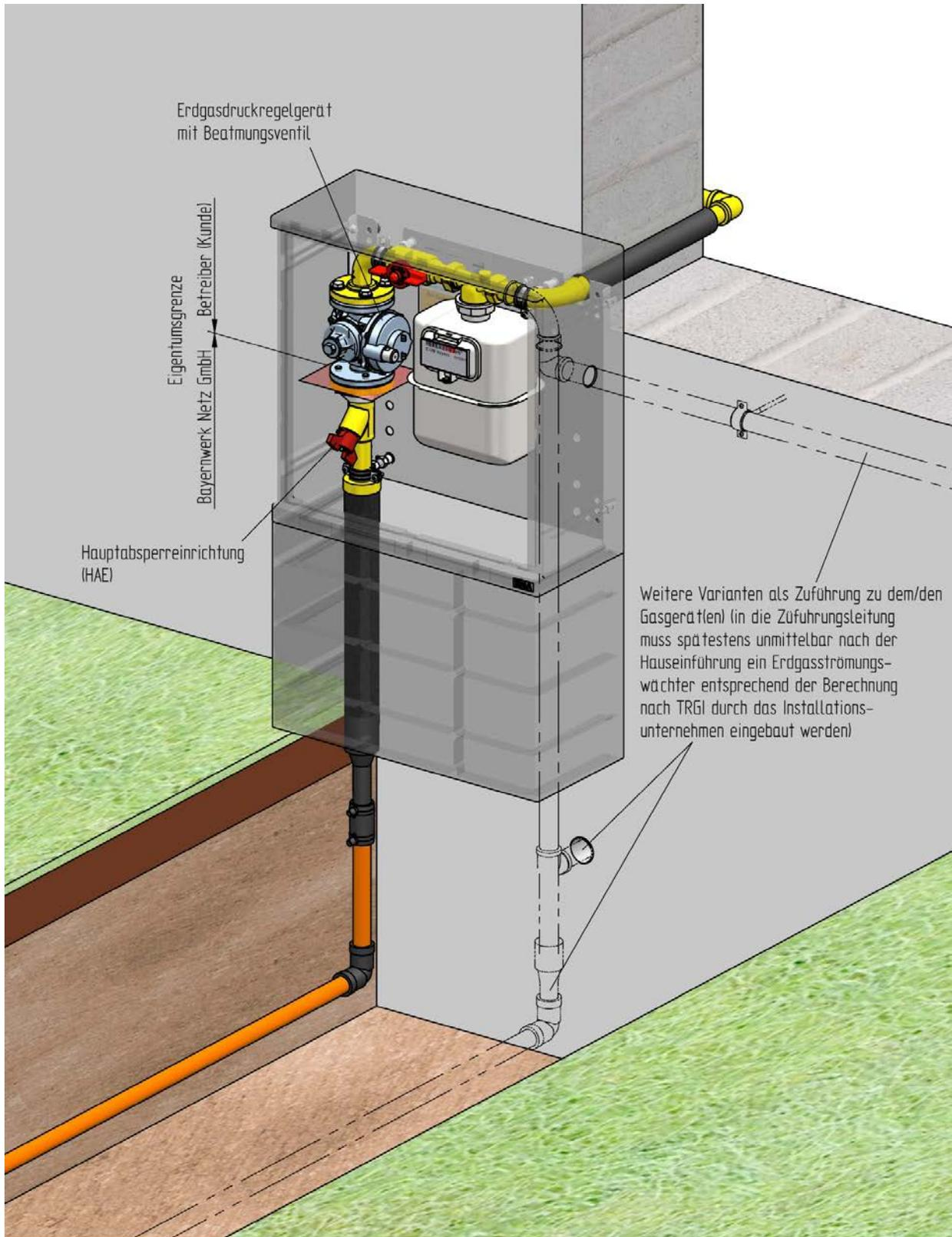
Die Befestigung des Kastens und der Hausanschlusskomponenten mit einer metallenen Montageplatten an der Außenwand kann bei fachgerechter Montage als ausreichende Ausziehsicherung für alle Einführungsvarianten im Sinne des Arbeitsblattes G459/1 angesehen werden.
