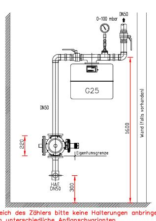
Im Anflanschbereich des Zählers bitte keine Halterungen anbringen, da es herstellerbezogen unterschiedliche Anflanschvarianten (Stehbolzen M10, Losflansch DP 10) gibt.
