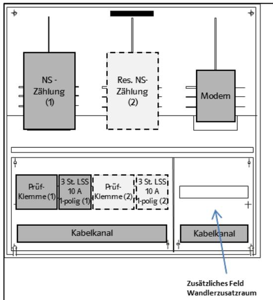
Abbildung 1: Schema Isolierstoffmontageplatte nach VBEW Merkblatt
