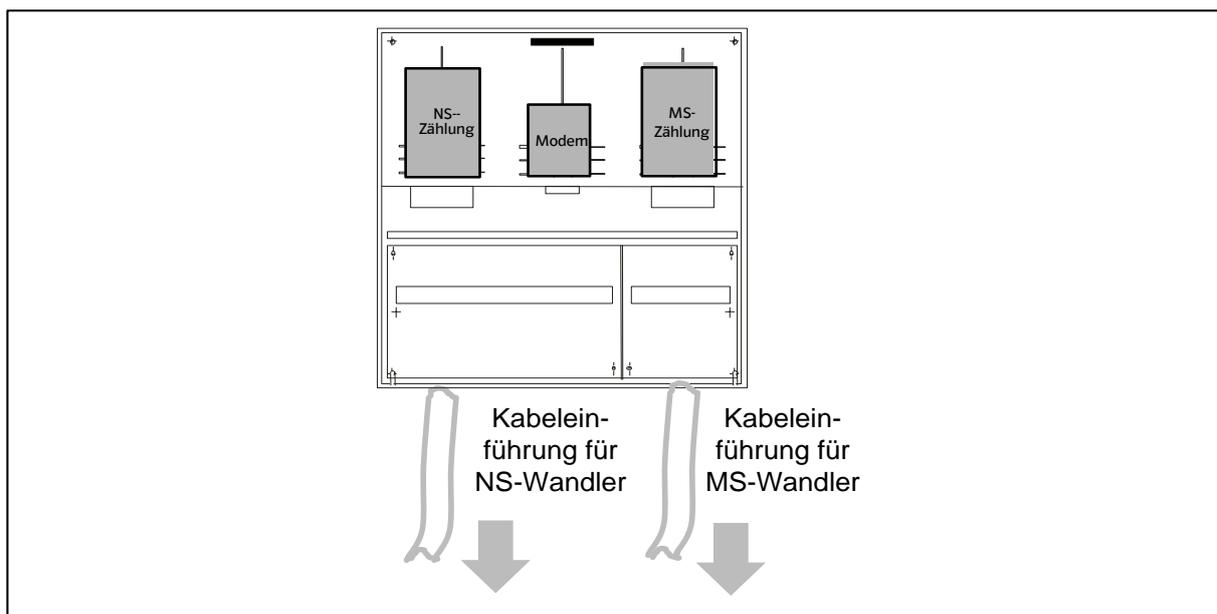
Abbildung 5: MS- und eine NS-Wandlermessung in einem Zählerschrank bei beengten Platzverhältnissen
