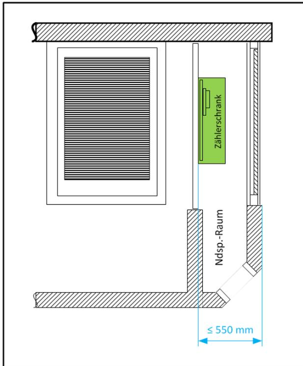
**Abbildung 2: Montagemaß Zählerschrank in nicht begehbarer Übergabestation**
